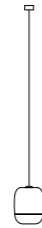
S1 MINI CANOPY Ceiling Rose Ø 40 mm H 15 mm Cable 3000 mm Diffuser Ø 135 mm H 165 mm
